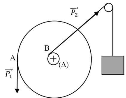
Le rayon de la roue est de 2,25 m et le treuil a un rayon de 0,30 m.
